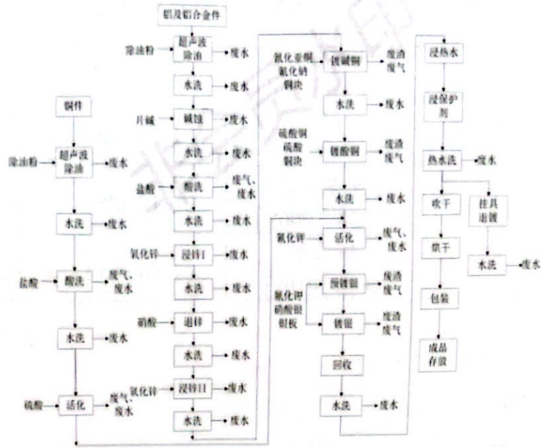
图 3.2.2 镀银生产工艺流程图
